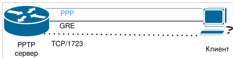
Рисунок 1 - VPN удаленного доступа на основе протокола PPTP
