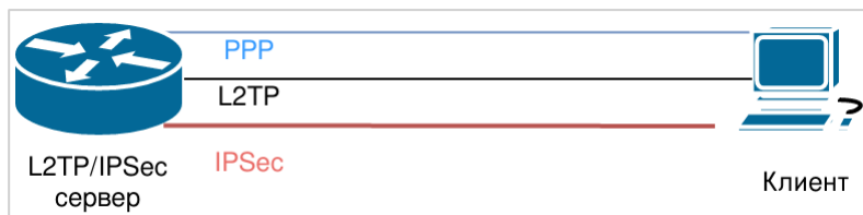
Рисунок 2 - VPN удаленного доступа на основе протокола L2TP/IPSec
